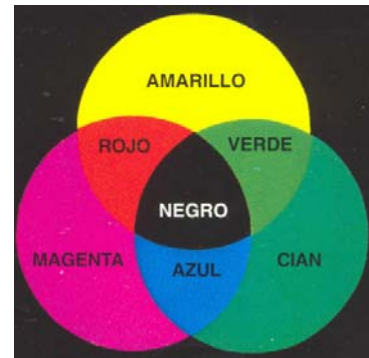
Figura 3.1.6: Mezclas de pigmentos (sustracción de secundarios).
