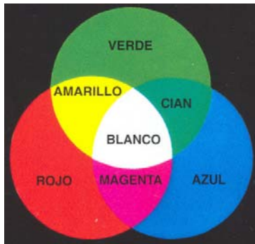
Figura 3.1.5: Mezclas de luz (adición de primarios)
