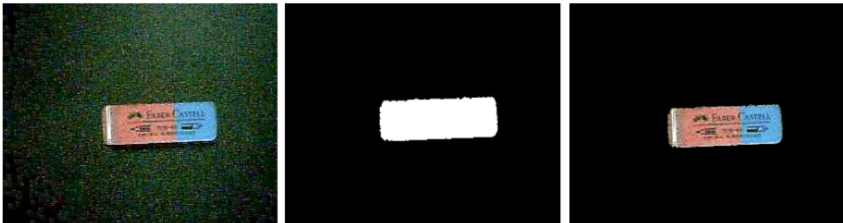
Figura 10.3.4 Multiplicación de matrices punto a punto: A) imagen en color, imagen en blanco y negro, C) imagen resultado de la multiplicación.
