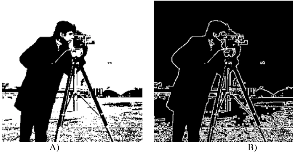
Figura 4.8.9: Extracción de frontera: A) imagen binaria, B) el resultado de aplicar extracción de frontera
