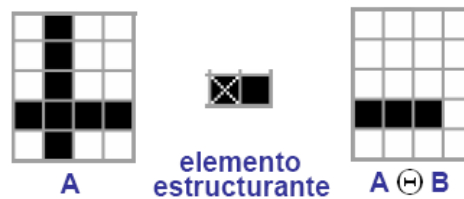
Figura 4.8.4. Erosión con un elemento estructurante de 1x2
