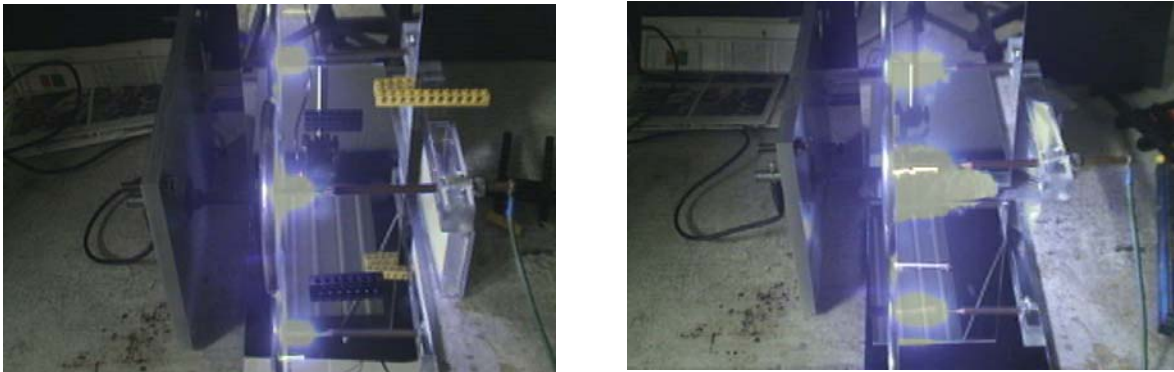
Figura Re-7 a) luminiscencia en geometría de electrodos punta-plano con una separación de 20 mm, utilizando cámara digital y arreglo de espejos. b) streamer capturado en el electrodo y en la reflexión del espejo inferior.
