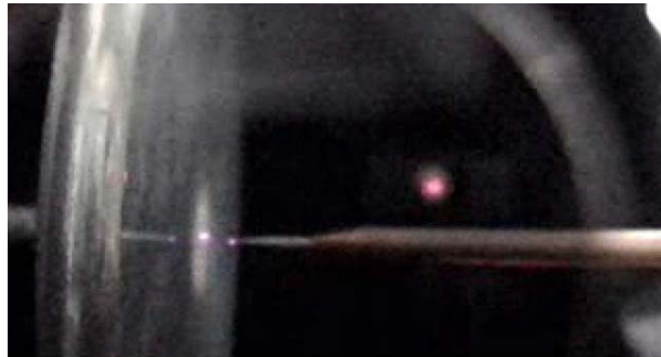
Figura Re-1 Descarga eléctrica en configuración punta-plano tomada con cámara analógica, utilizando tarjeta de adquisición de video.
