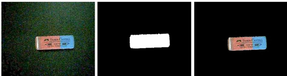
Figura 9.3.4 Multiplicación de matrices punto a punto: A) imagen en color, imagen en blanco y negro, C) imagen resultado de la multiplicación.
