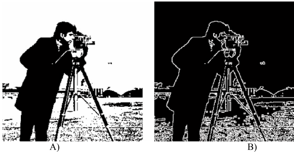
Figura 4.8.8: Extracción de frontera: A) imagen binaria, B) resultado de aplicar extracción de frontera.
