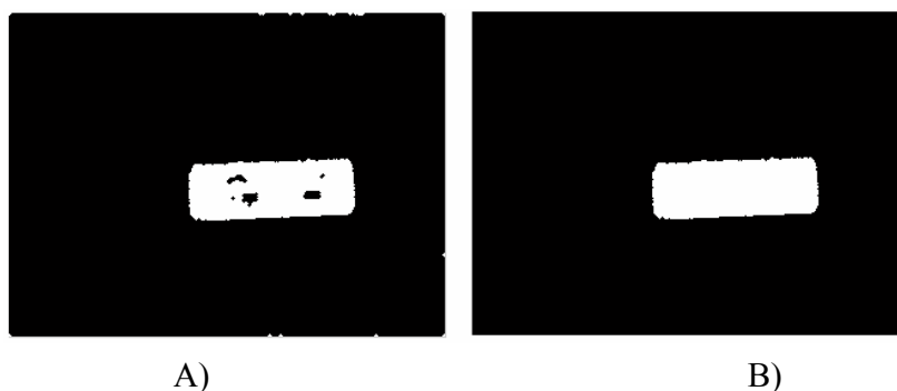
Figura 9.3.3 Eliminación de huecos y pequeños objetos: A) imagen con huecos y pequeños puntos, B) Resultado de aplicar las funciones “imfill” y “bwareaopen” .
