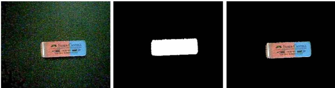
Figura 9.3.4 Multiplicación de matrices punto a punto: A) imagen en color, imagen en blanco y negro, C) imagen resultado de la multiplicación.
