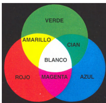
Figura 3.1.5: Mezclas de luz (adición de primarios)
