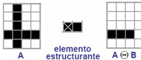
Figura 4.8.4. Erosión con un elemento estructural de 1x2
